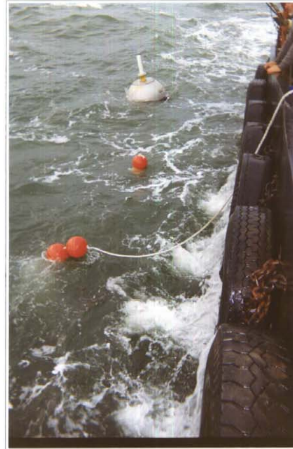
FOTO8 : Fondeo y olígrafo en el agua..
