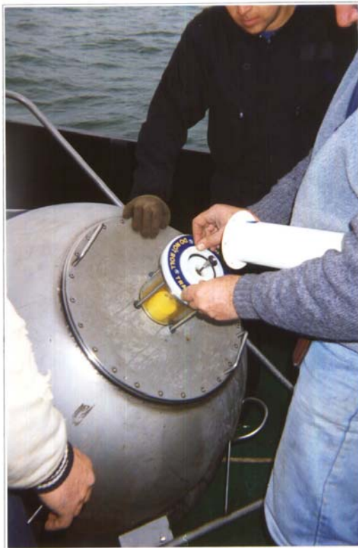
FOTO 1: Colocando antena en la boya ológrafo "Waverider".
