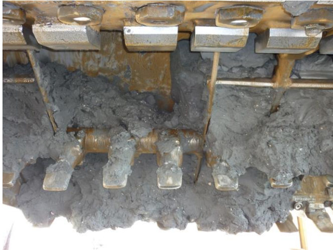
Figura 9.30 – Cabezal bloqueado por material arcilloso
