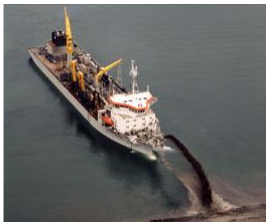
Figura 9.18 (a) – Descarga mediante chorro de proa
