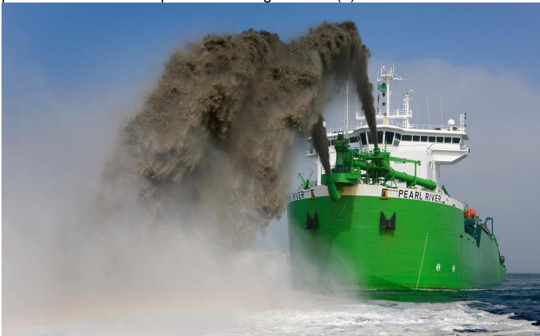
Figura 9.18 (b) – Descarga mediante dos chorros de proa
