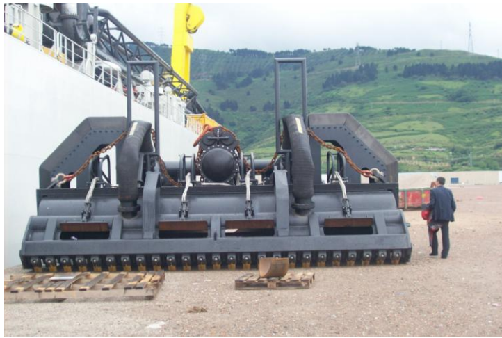
Figura 9.7 (b) – Cabezal de la draga Leiv Eriksson
