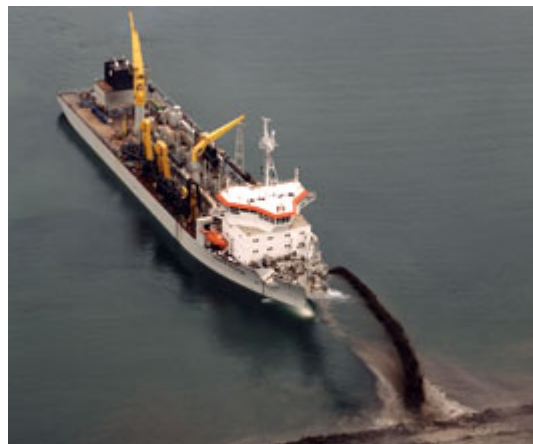
Figura 9.16 – Descarga mediante chorro de proa
