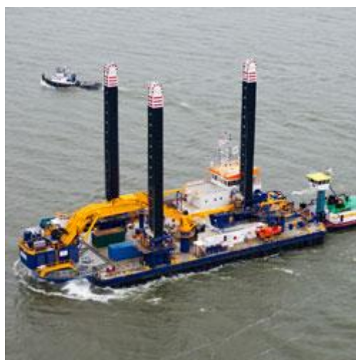
Figura 8.2 – Draga con el brazo recogido y empujada por un remolcador
