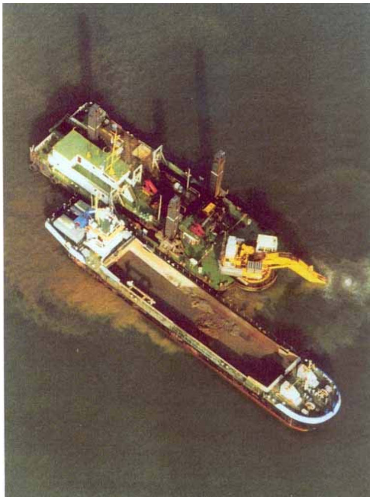
Figura 8.6 – Draga con barcaza tipo Split
