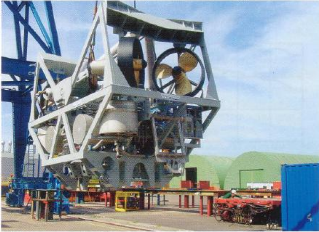
Figura 7.8 – ROV con marco de protección antes de integrarse con la cuchara
