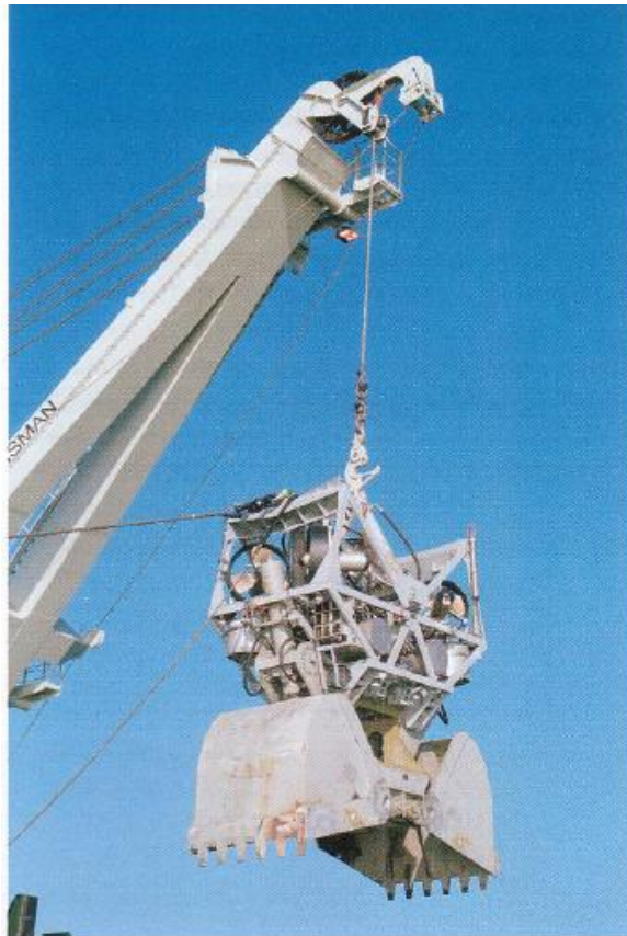
Figura 7.8 – ROV con marco de protección antes de integrarse con la cuchara
