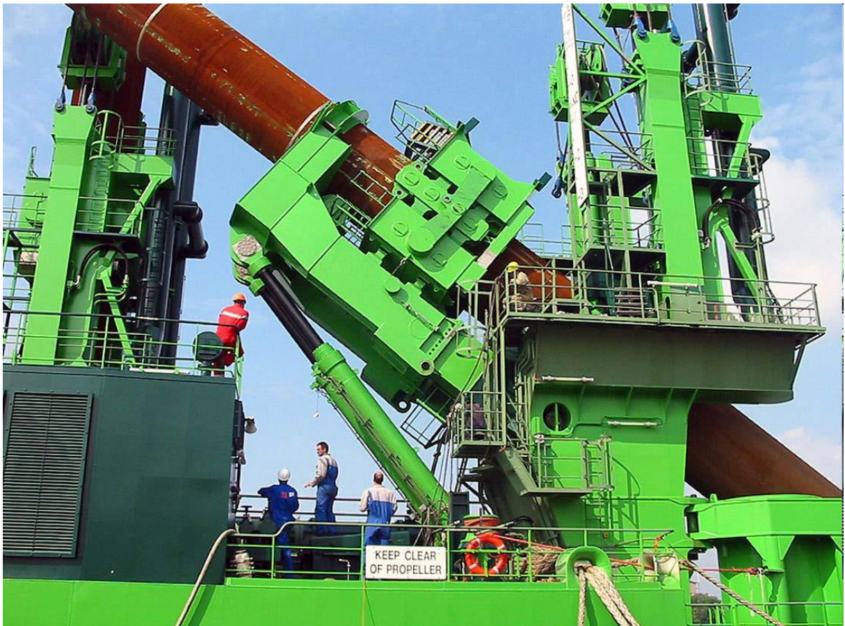
Figura 14.16 – Los pilones se pueden rebatir por sus propios medios
