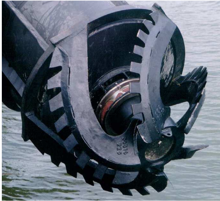
Figura 14.9 – Cortador con hojas de corte en forma de sierra soldadas
