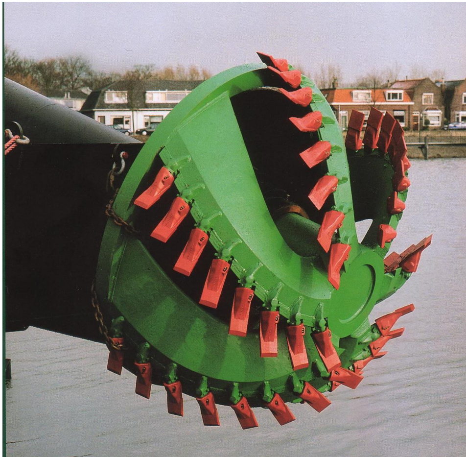
Figura 14.12 - Cortador incluyendo el sistema de dientes de la CSD 6516 C - IHC
