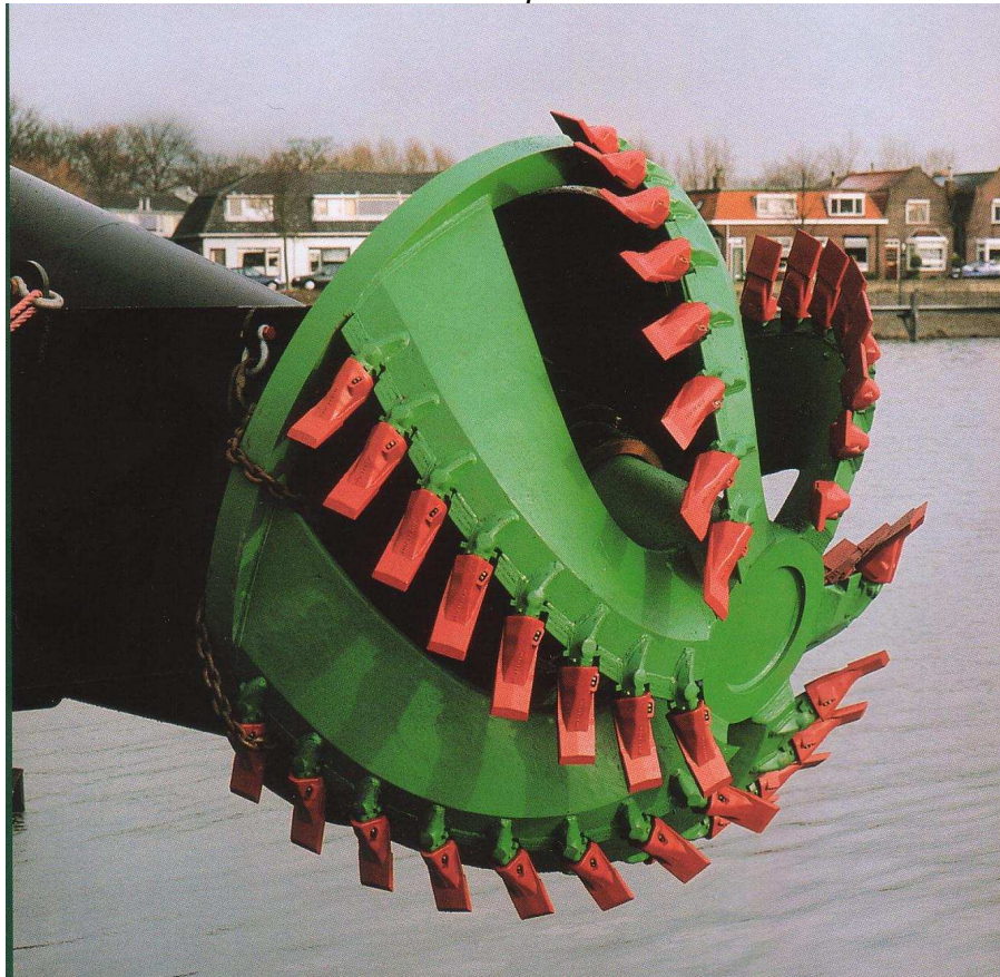
Figura 14.12 - Cortador incluyendo el sistema de dientes de la CSD 6516 C diseñado por IHC
