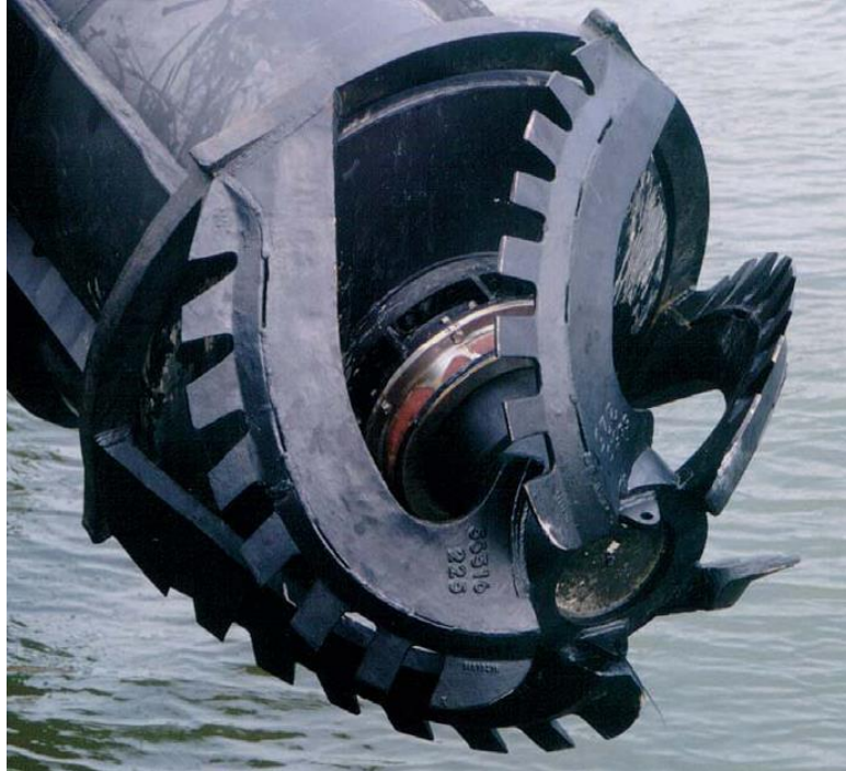
Figura 14.9 – Cortador con hojas en forma de sierra soldadas
