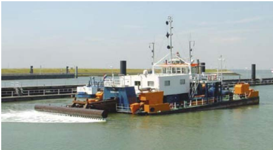
Figura 12.2 – Draga por inyección de agua
