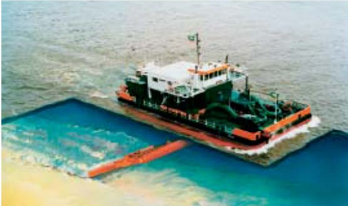
Figura 12.1 – Draga por inyección de agua Jetsed
