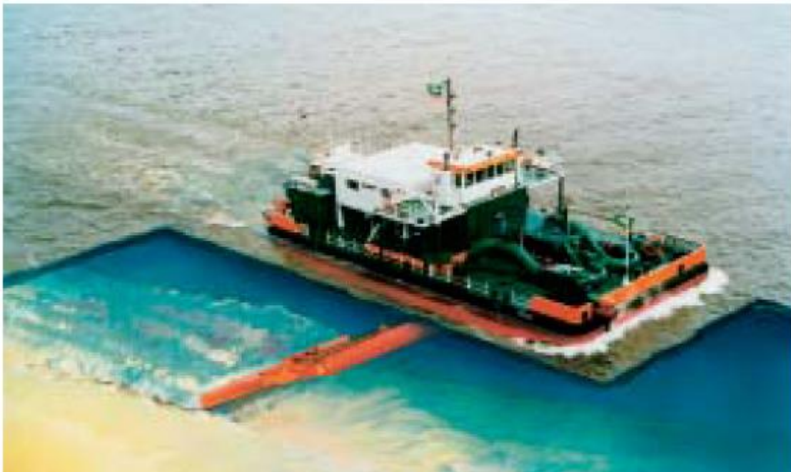
Figura 12.4 – Draga por inyección de agua Jetsed
