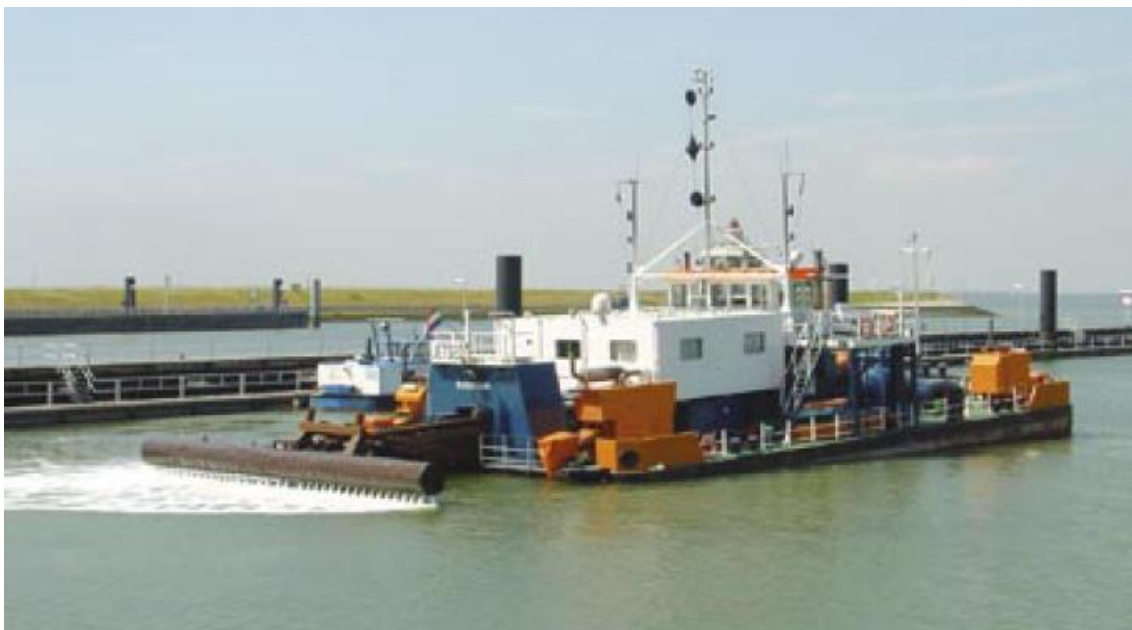
Figura 12.7 – Draga por inyección de agua
