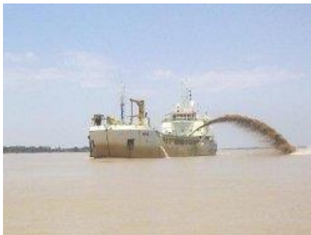
Figura 12.11 – Draga Niña realizando descarga lateral
