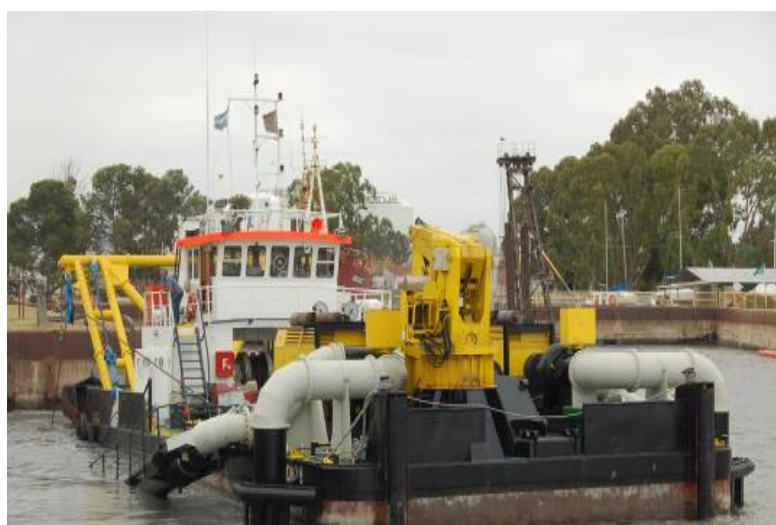
Figura 12.8 – Pontón DN28 equipado como draga por inyección de agua
