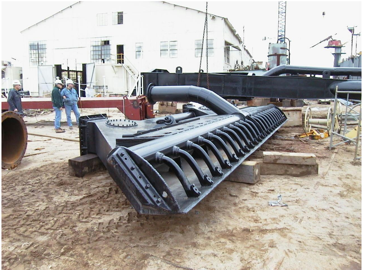
Figura 11.4 – Cabezal de dragado draga Dustpan
